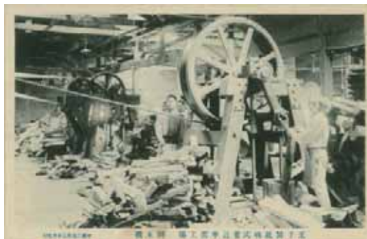
④ 王子製紙株式会社中部（なかべ）工場 割木機 ※渋沢史料館所蔵
